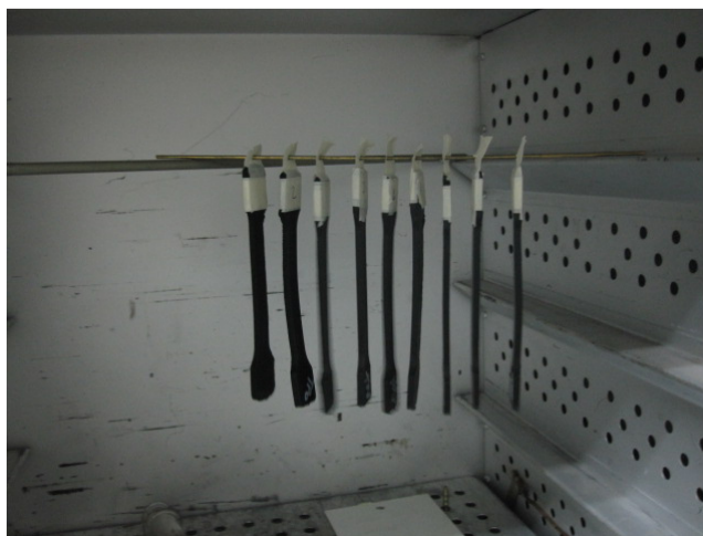
Figura 1.8 - Corpos de prova em envelhecimento
