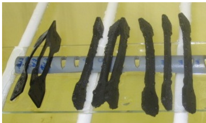
Figura 3.1: Corpos de prova – EPDM, TPE e TPV
