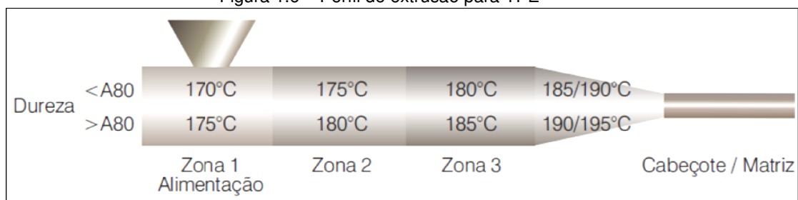
Figura 1.7 – Perfil de extrusão para TPO
