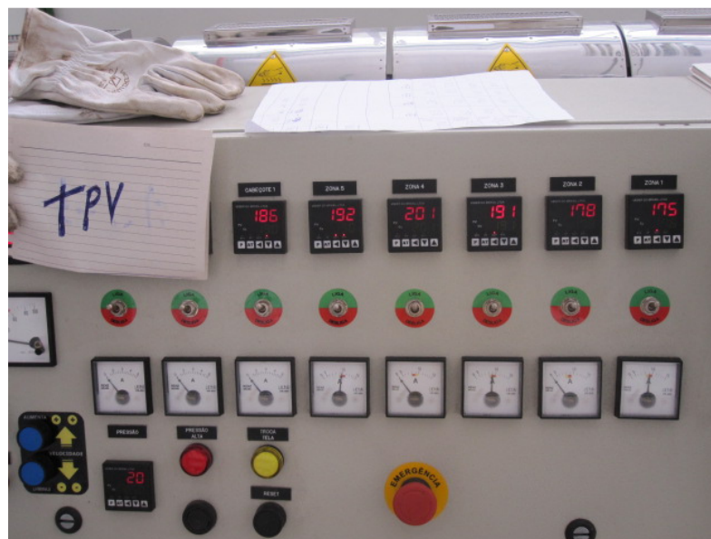
Figura 2H: Parâmetros de temperatura das zonas de extrusão.
