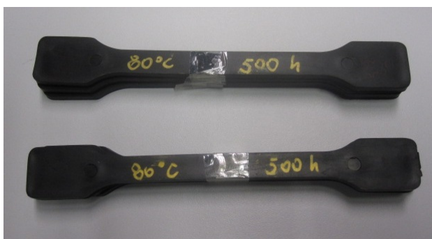
Figura 2.6: Corpos de prova após 500 horas à 80° C
