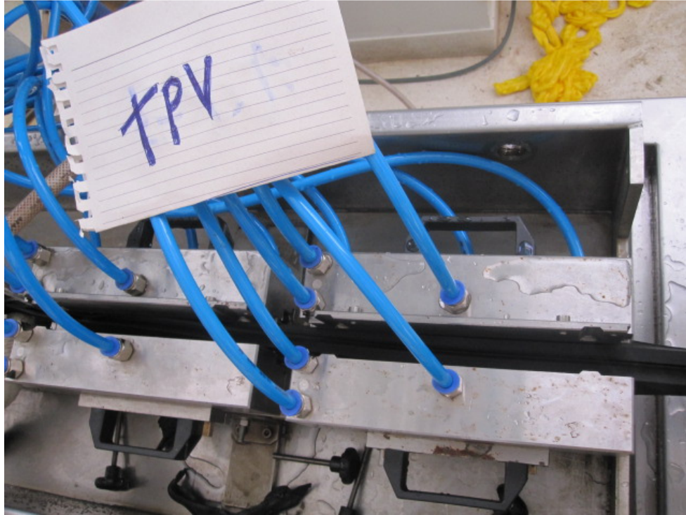
Figura 5H: Processo de resfriamento dos perfis.
