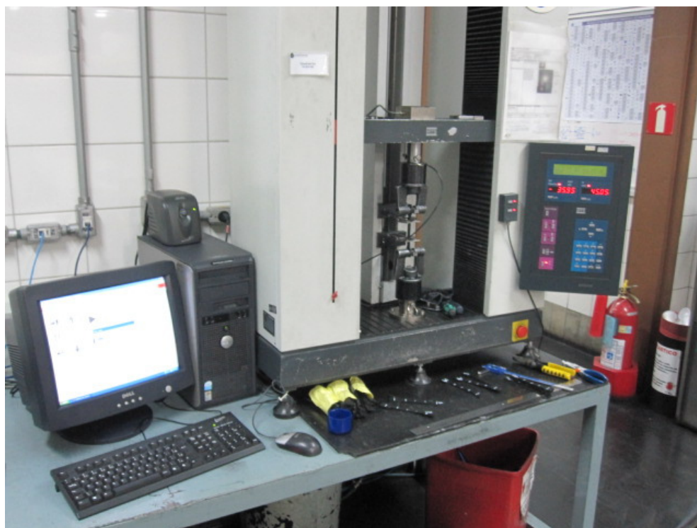
Figura 2l: Medição do corpo de prova para ensaio de tração.
