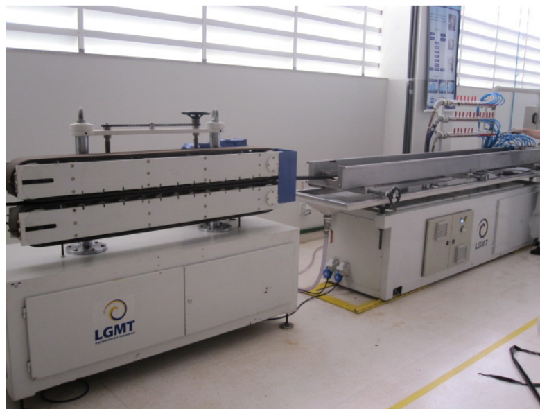
Figura 1H: Vista em perspectiva da linha de extrusão de perfilados.
