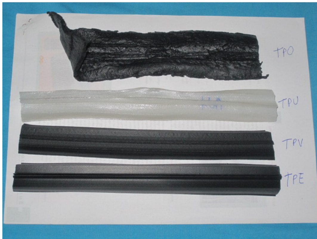
Figura 7H: Resultado dos ensaios de extrusão.
