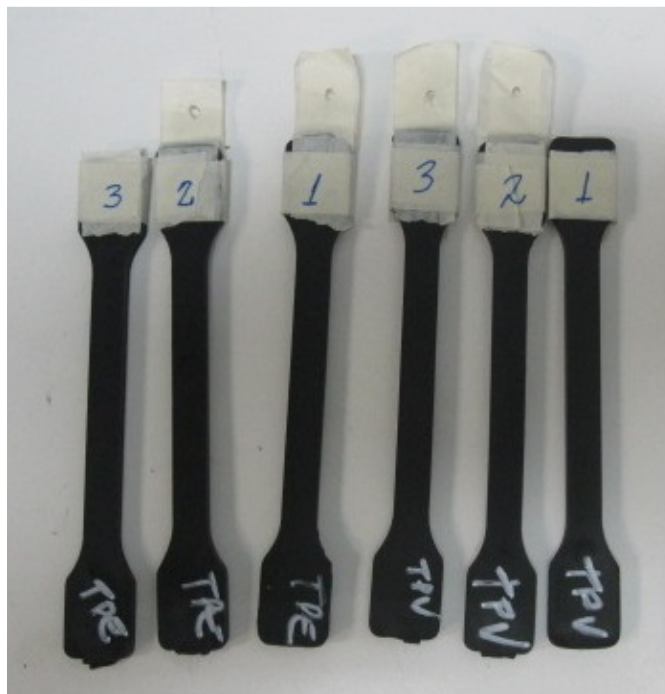
Figura 11: Preparação dos corpos de prova para envelhecimento térmico.
