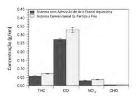
Figura 4 – Concentração de hidrocarbonetos, Monóxido de Carbono, Óxidos de Nitrogênio no teste US FTP-75. [3]
