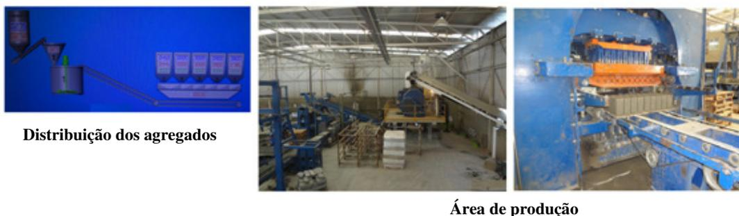
**Figura 2: Fabricação dos blocos vazados de concreto. Fonte: Autora do Trabalho, 2014.**
