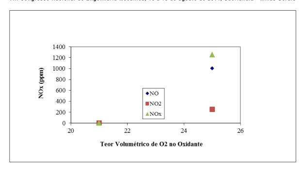
Figura 6. Emissão de NOx para  $\Phi = 1,1$  e teores de  $O_2$  de 21 e 25%.
