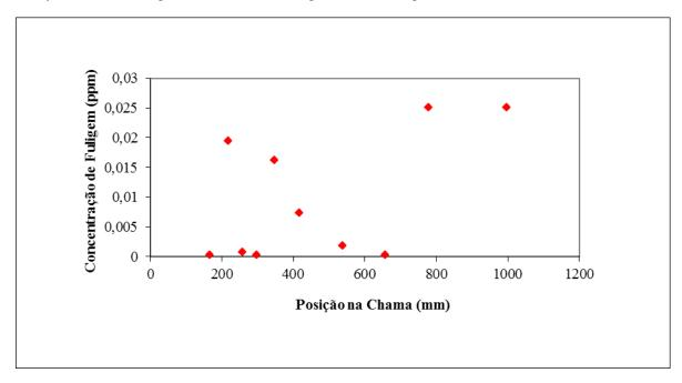
Figura 7. Concentração de fuligem ao longo da chama para  $\Phi = 0.9$  e teor de  $O_2$  de 21%.
