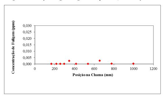
Figura 9. Concentração de fuligem ao longo da chama para  $\Phi = 0.9$  e teor de  $O_2$  de 25%.
