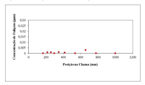
Figura 8. Concentração de fuligem ao longo da chama para  $\Phi = 1,1$  e teor de  $O_2$  de 21%.
