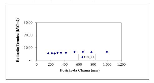
Figura 11. Radiação Térmica ao longo da chama para  $\Phi = 0.9$  e teor de  $O_2$  de 21%.
