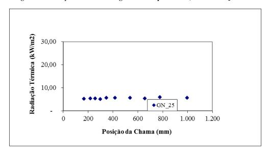
Figura 12. Radiação Térmica ao longo da chama para  $\Phi = 0.9$  e teor de  $O_2$  de 25%.
