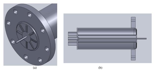
Figura 3. (a) Vista do Queimador com Swirl (b) vista em Corte do queimador com Swirl.
