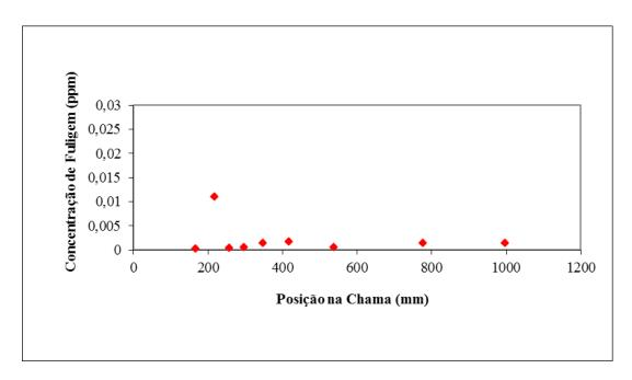
Figura 10. Concentração de fuligem ao longo da chama para  $\Phi = 1,1$  e teor de  $O_2$  de 25%.
