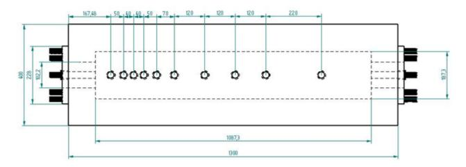
Figura 2. Vista longitudinal da câmara de combustão.
