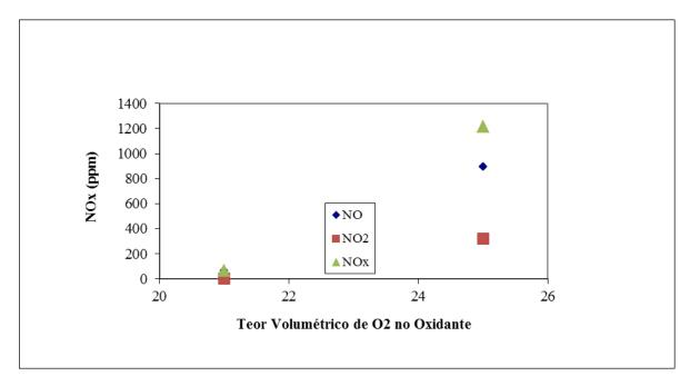
Figura 5. Emissão de NOx para  $\Phi$  = 1,0 e teores de  $O_2$  de 21 e 25%.
