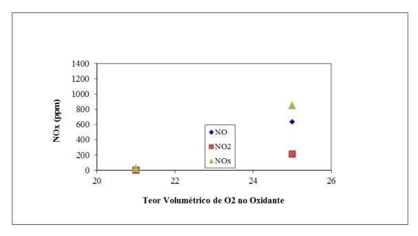
Figura 4. Emissão de NOx para  $\Phi$  = 0,9 e teores de  $O_2$  de 21 e 25%.
