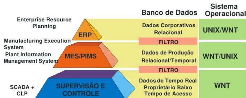
Figura 8 – Integração do chão de fábrica com o ERP com o PIMS (SEIXAS FILHO, 2005)
