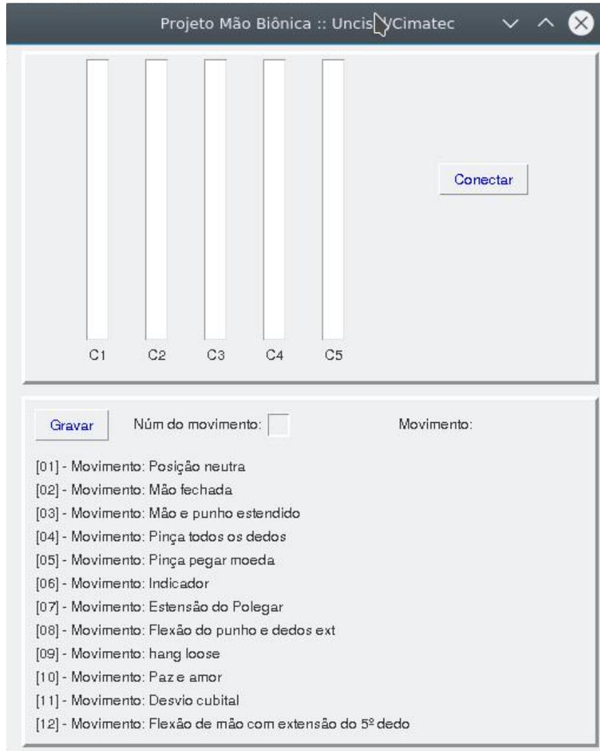
Figura 3.7: Interface de aquisição do sistema de captura do sinal mioelétrico.
