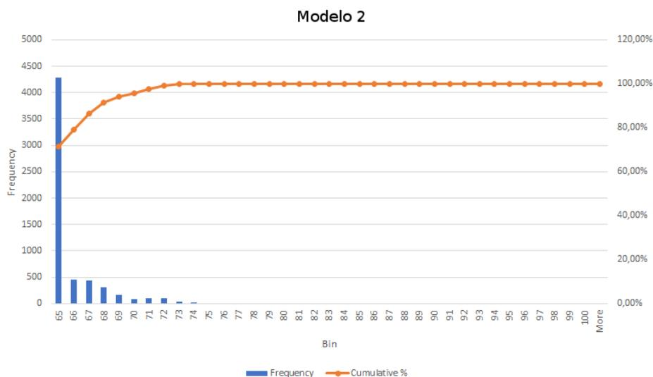
Figura 4.3: Histograma dos sinais obtidos com o eletrodo modelo 2 na fase de repouso. *fonte: próprio autor.*
