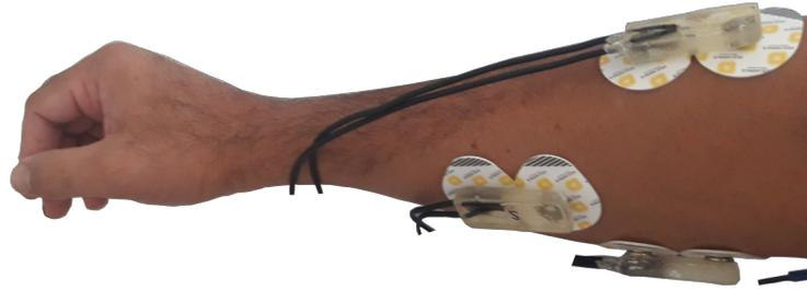
Figura 3.24: Posicionamento dos três canais com suporte no antebraço. *Fonte: próprio autor*
