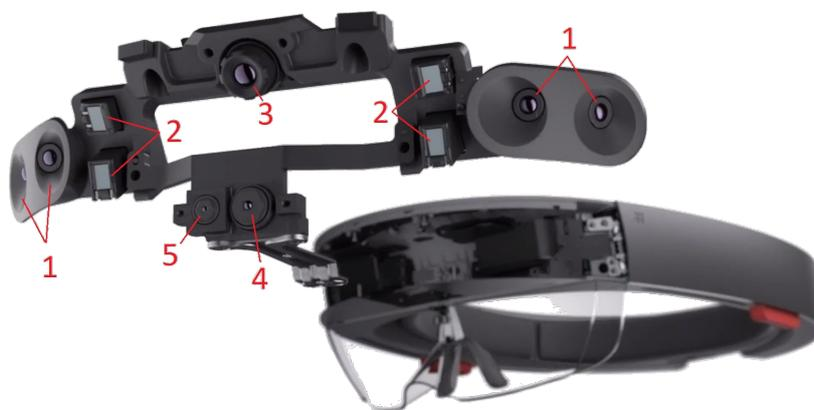
Figura 2.1: Sensores do HoloLens. 1) Câmeras de compreensão do ambiente. 2) Projetores a laser infravermelho. 3) Câmera de profundidade. 4) Câmera de alta definição. 5) Sensor de luminosidade (LIU et al., 2018).
